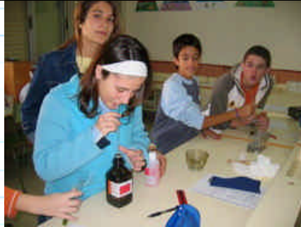
8- Afig, en la pipeta i el tub d'assaig inclinats per a que rellisque per les parets, 5 ml de éter de petroli.
